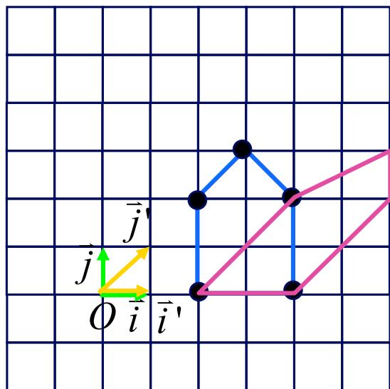
$$\begin{pmatrix} y'_1 \\ y'_2 \\ 1 \end{pmatrix} = \begin{bmatrix} 1 & 1 & 0 & 0 \\ 0 & 1 & 0 & 0 \\ 0 & 0 & 1 & 0 \\ 0 & 0 & 0 & 1 \end{bmatrix} \begin{pmatrix} x_1 \\ y_2 \\ 1 \end{pmatrix}$$
